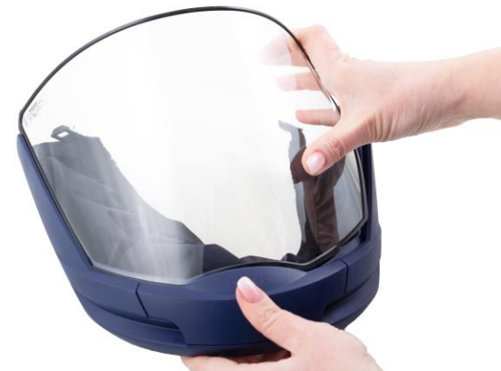
5.4 Montera siktskivan i den undre visirramen. Lite vatten på tätningen underlättar montaget
